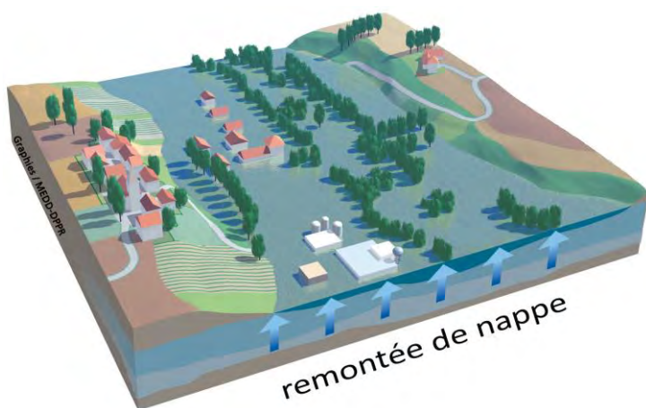
Inondations par remontée de nappes, source : BRGM
