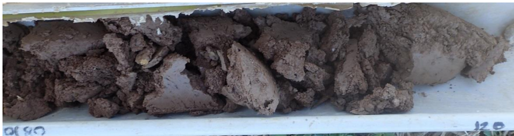
Échantillon prélevé entre 80 à 120 cm de profondeur – P. maximale : 120 cm
