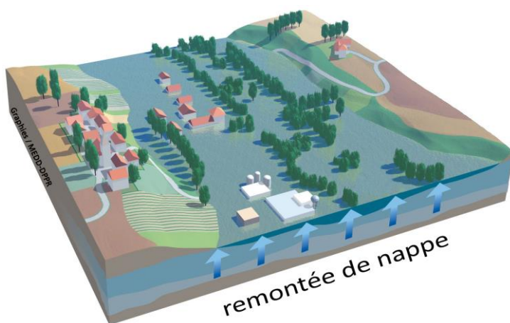
Inondations par remontée de nappes, source : BRGM
